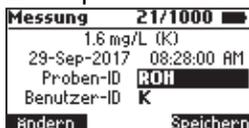
Der Wert wird mit Zeitstempel gespeichert. Es können bis zu 1000 Datensätze gespeichert werden.
