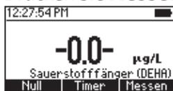
Das Display zeigt den Gehalt an DEHA (Diethylhydroxylamin) in µg/L.
