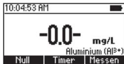
Das Display zeigt den Gehalt an Aluminium (Al<sup>3+</sup>) in mg/L.
