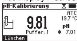
5. Optional: Drücken Sie **Löschen**, um die aktuelle Kalibrierung zu löschen.
