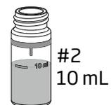
15. Setzen Sie zweite Küvette (#2) in den Messschacht und schließen Sie den Deckel.
