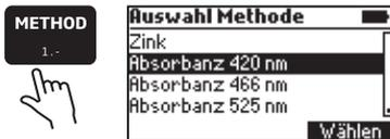
Sie können mit dem Gerät Absorbanzmessungen zu benutzerdefinierten oder diagnostischen Zwecken durchführen.
