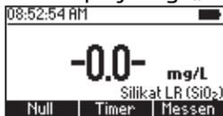
15. Nehmen Sie die Küvette aus dem Messschacht und geben Sie 1 Beutel Reagenz C (HI93705C-0) hinein.
