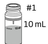
4. Setzen Sie die erste Küvette (#1, Nullprobe) in den Messschacht und schließen Sie den Deckel.
