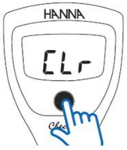
Öffnen Sie den Kalibriermodus und drücken Sie dann erneut dauerhaft die Taste. Es erscheint „CLr“ und die Kalibrierung ist gelöscht. Das Gerät setzt auf eine Standardkalibrierung zurück. Keine Symbole werden angezeigt.
