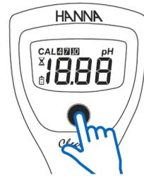
Schalten Sie das Gerät durch Drücken der Taste ein. Alle Elemente der Anzeige werden dabei kurz sichtbar sein, gefolgt von der aktuellen Messung und der kalibrierten Puffer. Anschließend geht das Gerät in den normalen Messmodus über.
