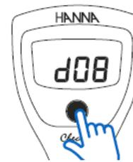
Schalten Sie das Gerät ein in den Messmodus. Halten Sie anschließend die Taste gedrückt. Es erscheint nacheinander: OFF, CAL und zuletzt d08 auf dem Display. Lassen sie die Taste los. Drücken Sie nun kurz die
